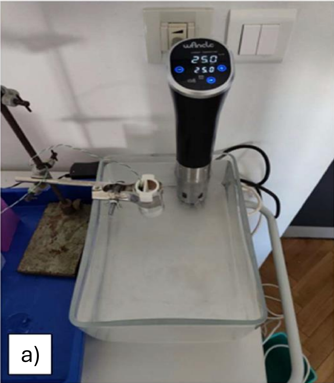
Slika 3. Ekperimentalni postav sustava za a) konduktometrijska, b) potenciometrijska mjerenja pri stalnoj temperaturi od 25,0 °C.
