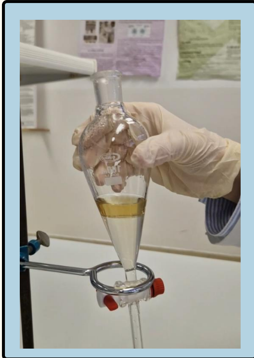
Slika 3. Odvajanje slojeva nakon provedene ekstrakcije
