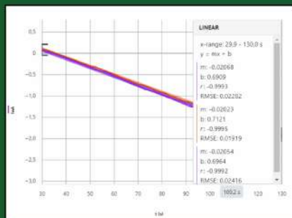
Slika 2. Ovisnost prirodnog logaritma apsorbancije \ln A o vremenu u otopini NaOH koncentracije 0,75 \text{ mol dm}^{-3} pri temperaturi 294,7 \text{ K} i ionskoj jakosti I = 1,50 \text{ mol dm}^{-3} za tri uzastopna mjerenja
