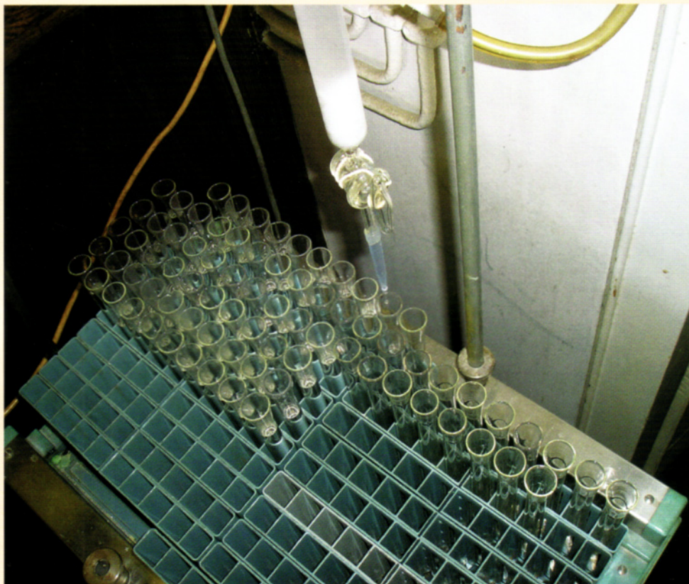
Slika 2. Sakupljač frakcija ( fraction collector ) dobro dođe kemičarima da ne moraju sami podmetati epruvete pod pipac.
